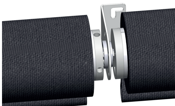
\leq 20 cm mellan rörbusningarna = 1 st seriekopplingskonsol
